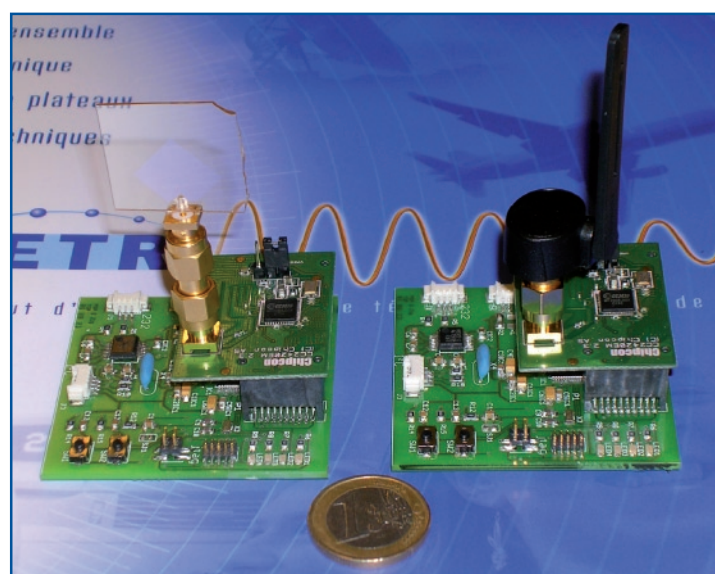
Modules ZigBee A droite avec l'antenne filaire standard. A gauche, monté avec une antenne monopole losange transparente
