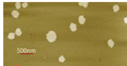
Observation au microscope à force atomique de phases lipidiques exposées à un rayonnement 60 GHz.
